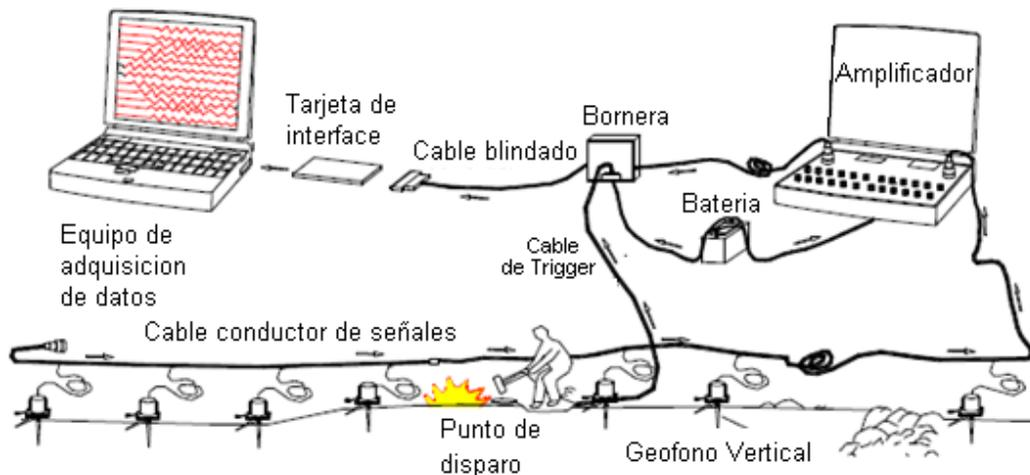
**Fig. 1.** Disposición del equipo para la adquisición de una traza sísmica.
