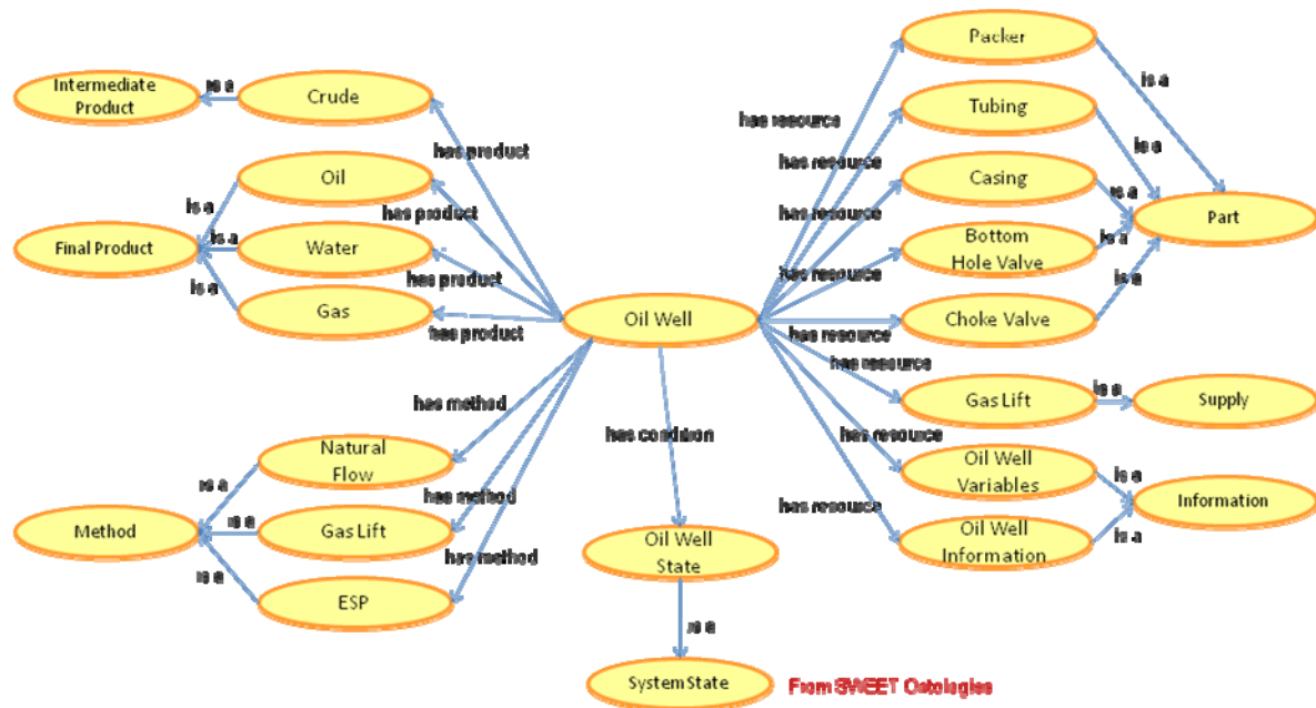
Fig. 10. Conceptos de la Unidad de Producción Pozo. OilProductionOntology
