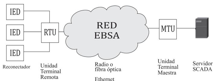
**Fig. 1.** Comunicación Empresa con RTU.
